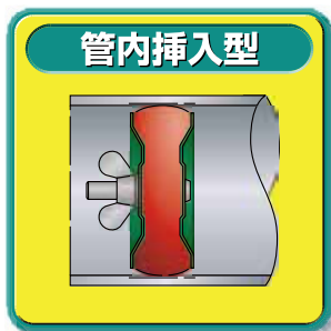
管の内部に挿入する
